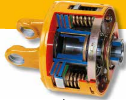
*Kupplungskennzeichnung Kombination von Reib- und Freilaufkupplung
