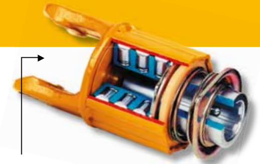
*30 = Drehmoment Drehmomentübertragung durch federbelastete Sperrkörper
